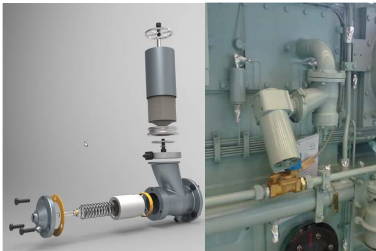
Explosionszeichnung eines Teillastoptimierungs-Ladeluftabblaseventils (links) und Nahaufnahme am Motor (rechts)
